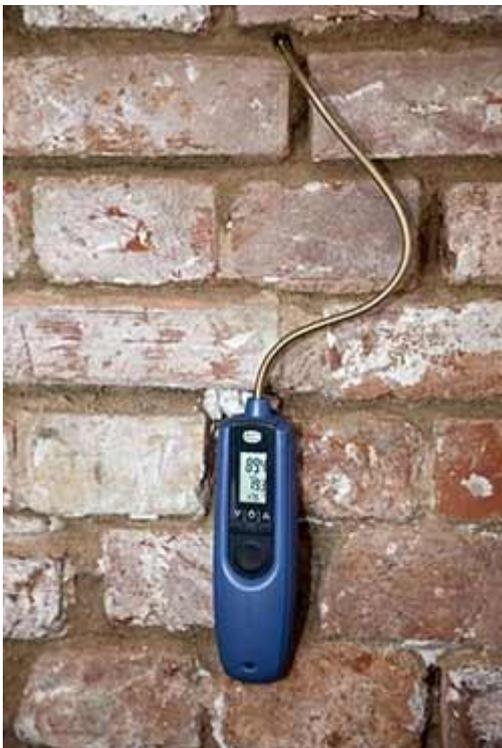
Medidor de humedad de equilibrio Hydromette BL Compact RH-T flex en la medición de una junta en un muro
