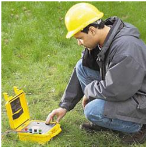
Controlador de puesta a tierra CA-6460 en uso
