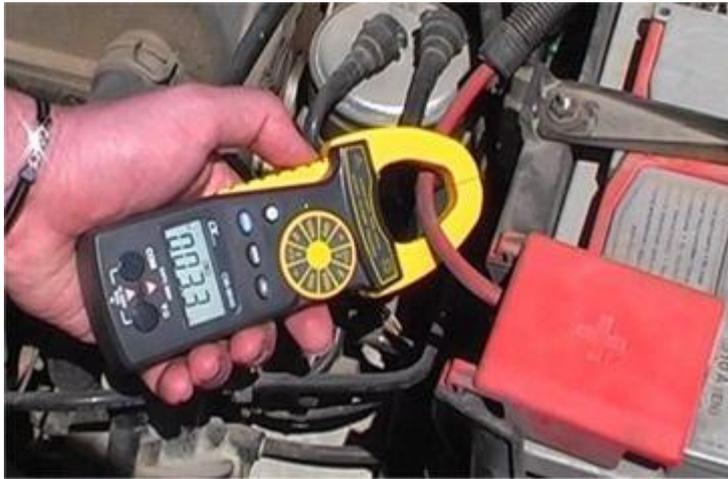
Amperímetro CM-9940 comprobando la intensidad que consume un motor al arrancar
