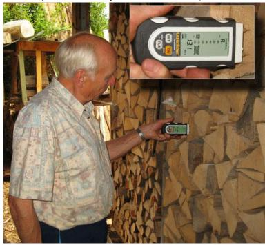
Con el medidor de humedad puede medir tanto en pino como en haya u otros materiales (de construcción).
