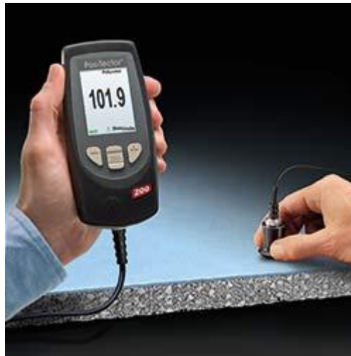
Medición del espesor de la pintura con el medidor de revestimiento
