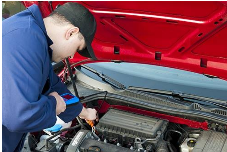
El fibroscopio PCE-DE 25N durante una inspección en el compartimiento del motor.
