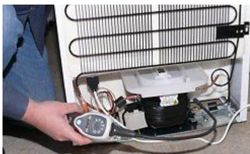
Detector de fugas siendo usado en un sistema de refrigeración
