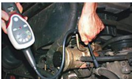
Detector de fugas siendo usado en un sistema de aire acondicionado
