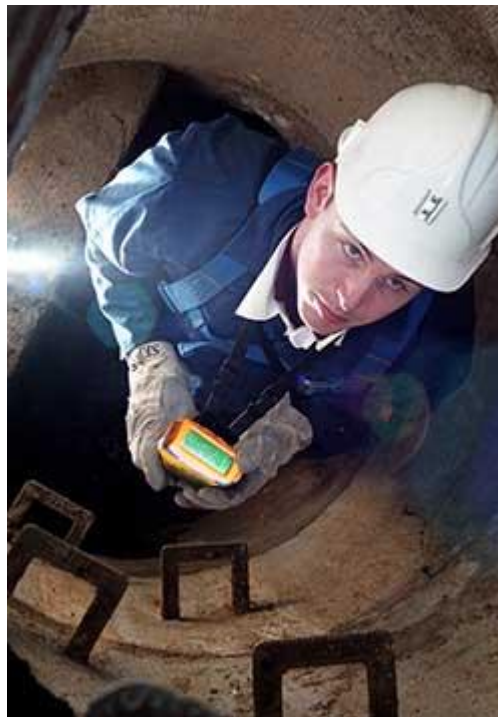
Medidor de gases Gas-Pro para proteger a una persona en un alcantarillado
