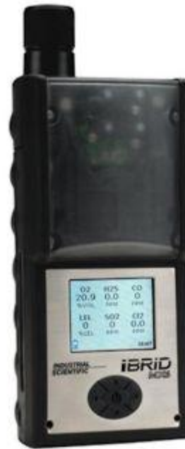
Aquí se observa la pantalla gráfica del analizador de gas MX6 iBRID
