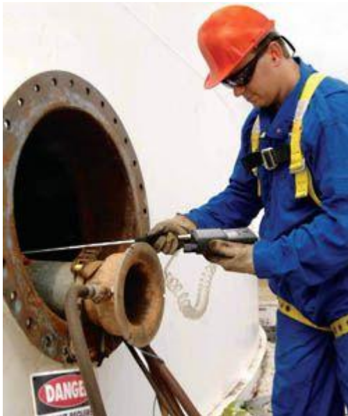
Aquí se ve el analizador de gas MX6 iBRID midiendo en un recipiente
