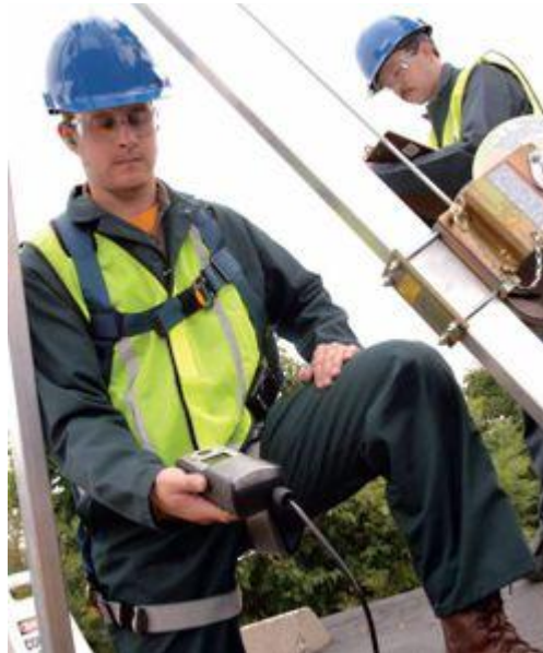
Aquí se observa el MX6 tomando muestras antes de entrar en una canalización
