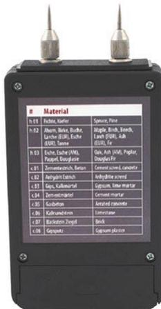
Imagen de la parte posterior del medidor de humedad GMR 110
