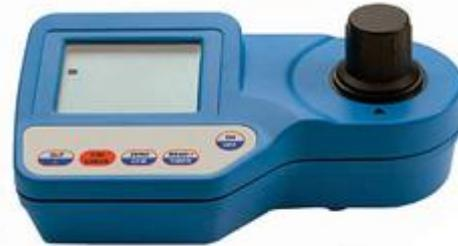
Medidor fotométrico de dureza de agua
