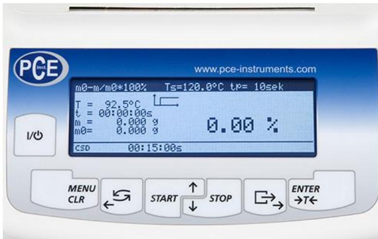
Imagen del display de la balanza de humedad
