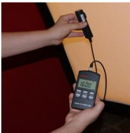
Comprobación de la iluminación en luxes con el luxómetro en un estudio de fotografía.
