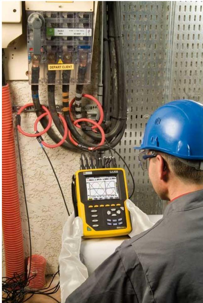
Medición de potencia con el analizador de energía y de potencia C.A 8335 QualiSTAR +
