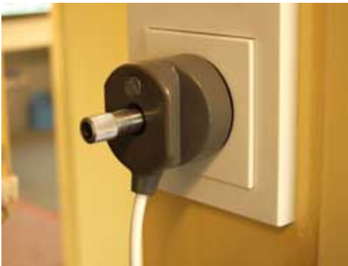
El medidor de elasticidad empleándose para la determinación de la elasticidad en un enchufe Schuco.
