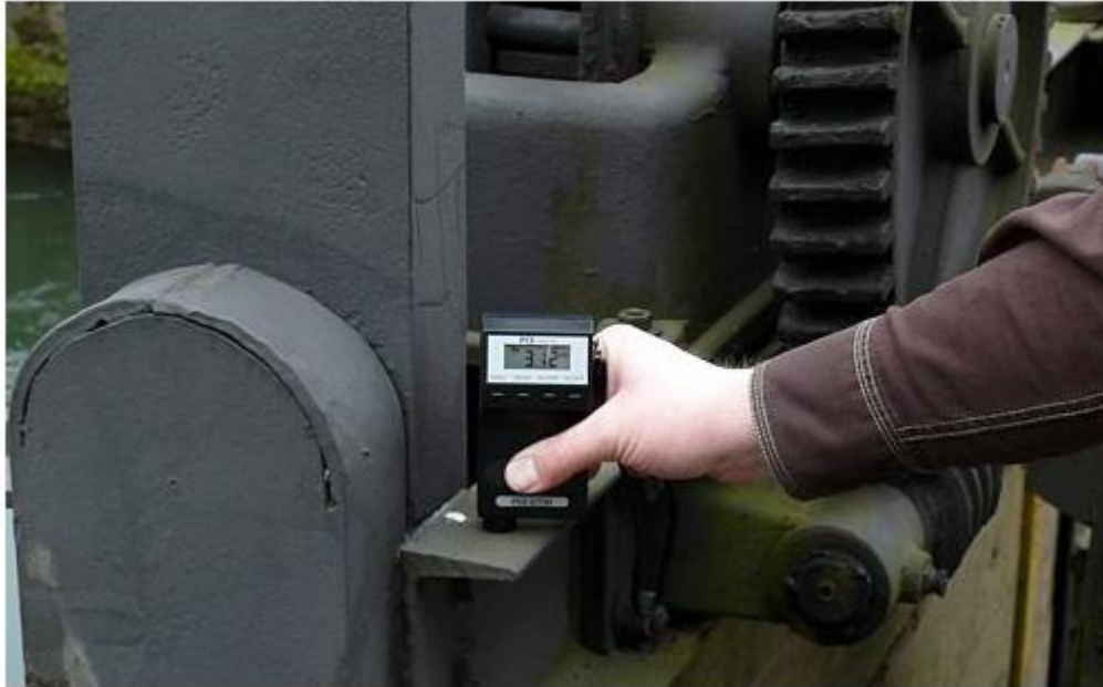
Aquí ve el medidor de espesor PCE-CT haciendo una medición.
