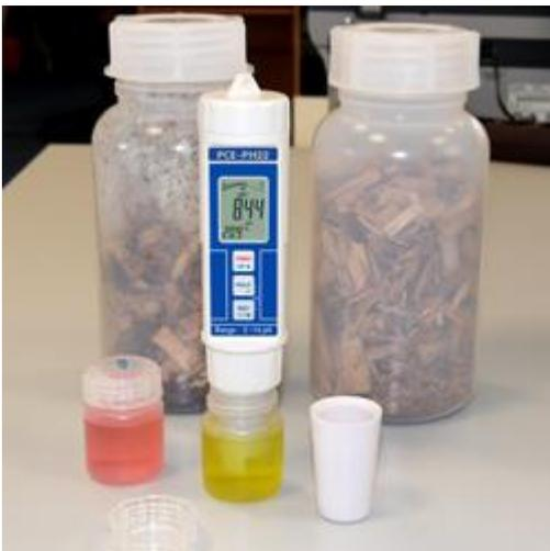
Esta imagen muestra el medidor de pH siendo calibrado. La calibración se efectúa con el set de calibración pH-4 y pH-7 incluido en el envío.
