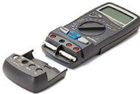
Multímetro Metrix MX24B con el compartimiento de fusible abierto
