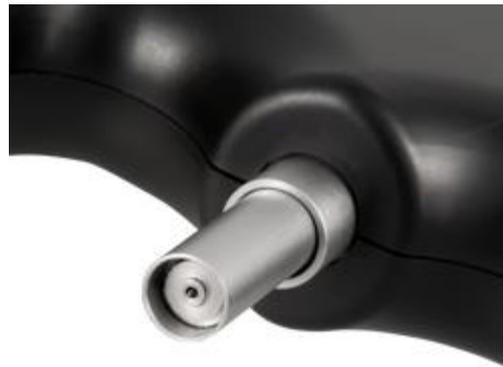
Punta de medición con aguja del durómetro Barcol.
