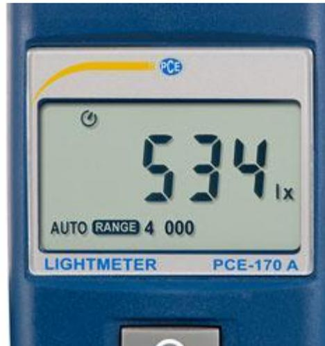
El luxómetro PCE-170A dispone de una gran pantalla LCD de 5 dígitos.
