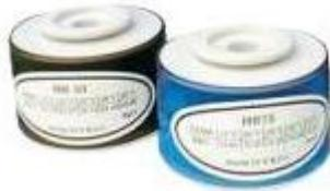
Al higrómetro PCE-313A le puede añadir un set de calibración como componente adicional. Todos los sensores de humedad suelen desviarse con el tiempo, cosa que también acaece a este modelo. Para poder prevenir tal desvío y asegurarse de obtener valores de medición precisos, es posible calibrar el higrómetro con dos estándares de calibración. La humedad de los estándares son de 33% y 75% de humedad relativa. El proceso de calibración puede ser efectuado por personas no iniciadas.
