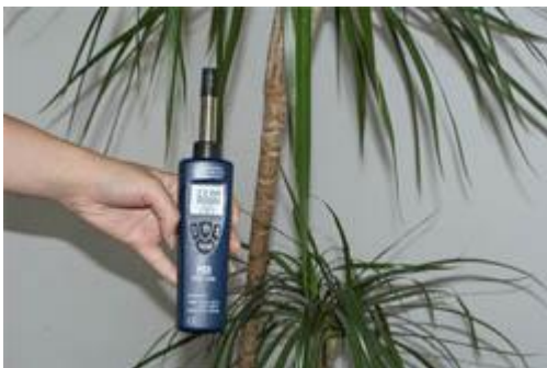
Midiendo la humedad ambiental de una estancia con el higrómetro PCE-555.
