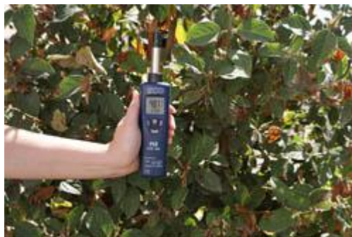
Vista frontal del higrómetro PCE-555, realizando una medición en el exterior de la humedad.
