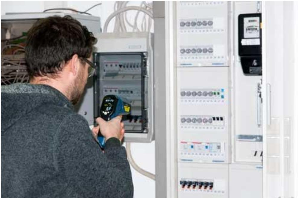
Uso del PCE-895 para controlar la temperatura en un armario de fusibles
