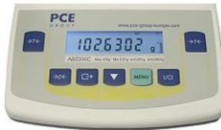
La pantalla de la balanza de análisis tiene iluminación de fondo (con ajuste de la intensidad) y dispone de un indicador de rango que muestra en el margen derecho el rango de pesado disponible.
