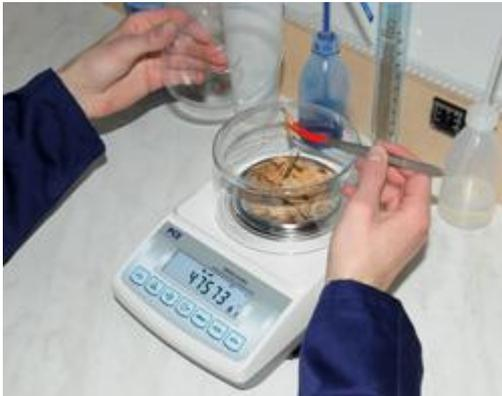
La balanza de precisión PCE-BT 200 con protector de viento desmontable
