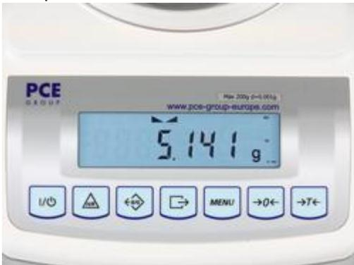
Aquí observa la alta resolución en pantalla de la balanza de precisión PCE-BT 200
