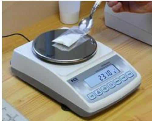
La balanza de precisión PCE-BT 2000 pesando una dosificación
