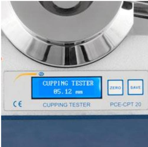
La pantalla de la máquina de embutición está situada en la parte frontal, donde el usuario realiza los ensayos. Se trata de una pantalla de fácil lectura con iluminación de fondo que permite al usuario leer con facilidad los valores incluso con cambios de iluminación ambiental.
