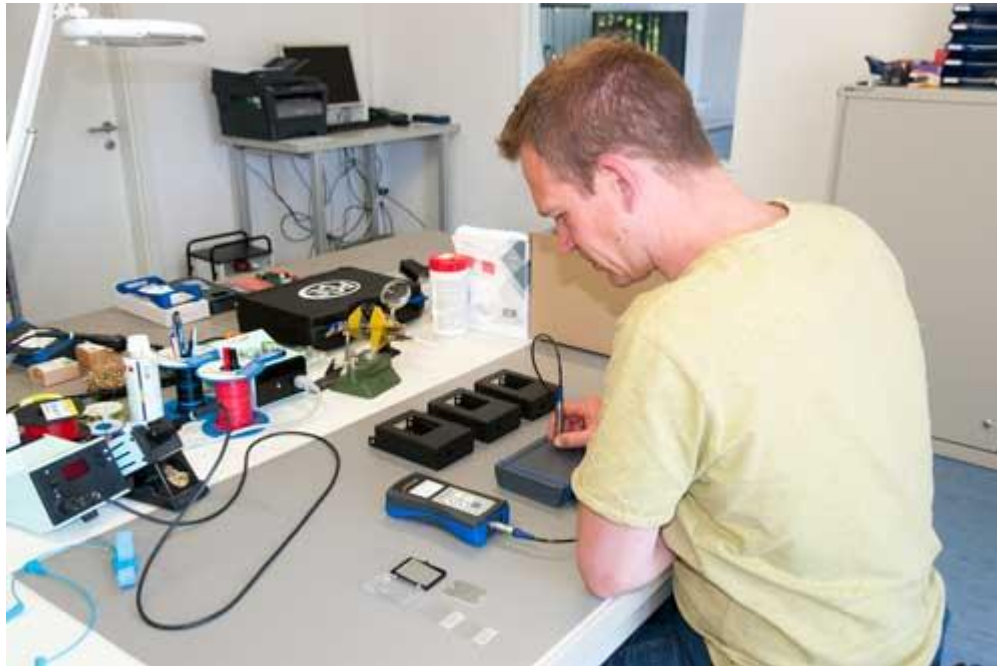
En esta imagen se observa una medición con el medidor de revestimiento PCE-CT 100 sobre una carcasa
