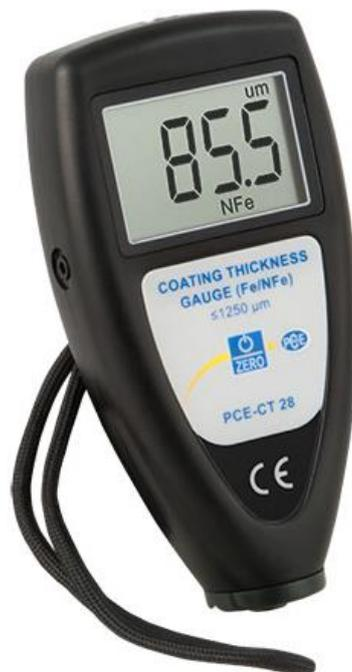
Medidor de recubrimiento PCE-CT 28
