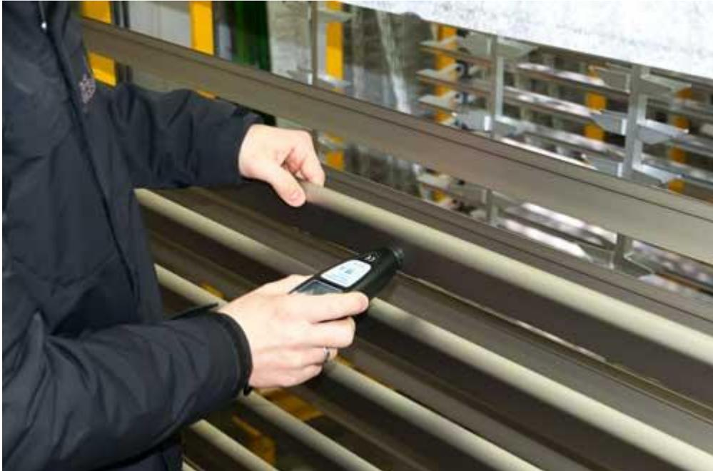
Comprobando el espesor de las persianas con el medidor de recubrimiento PCE-CT 28.
