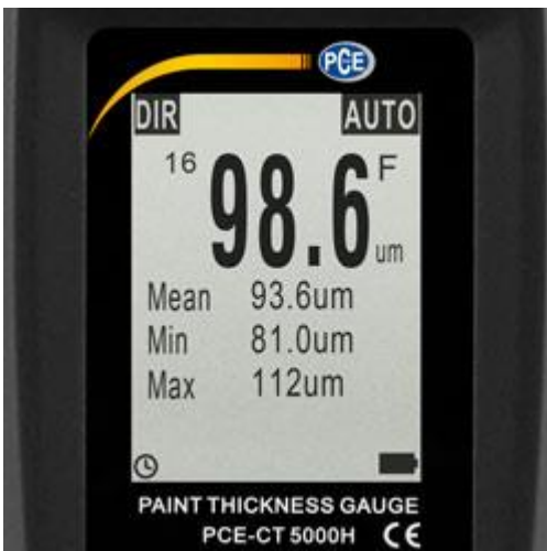
Pantalla del medidor de recubrimiento midiendo sobre un metal férrico (medición en \mu\text{m} ).
