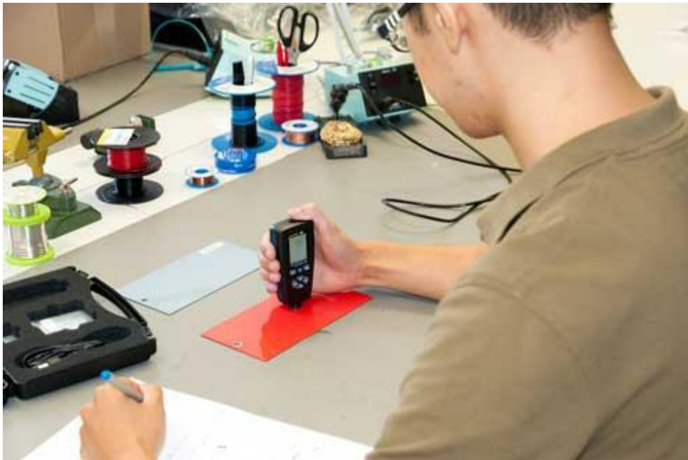
Usando el medidor de recubrimiento PCE-CT 5000H en el control de calidad.
