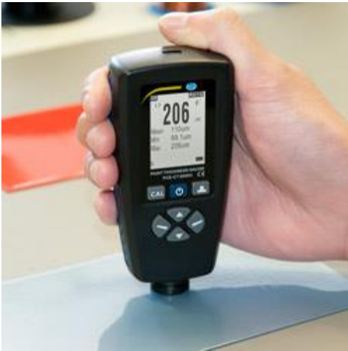
Midiendo con el medidor de recubrimiento PCE-CT 5000H sobre un metal férreo.
