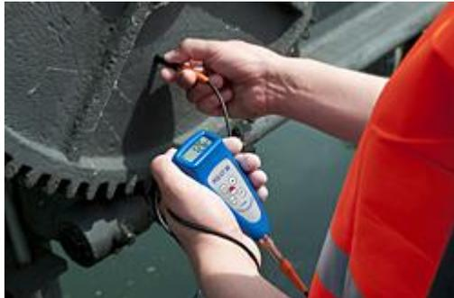
El medidor de espesor de capas realizando una medición de capa de pintura en una rueda dentada
