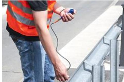
El medidor de espesor de capas comprobando una valla protectora.
