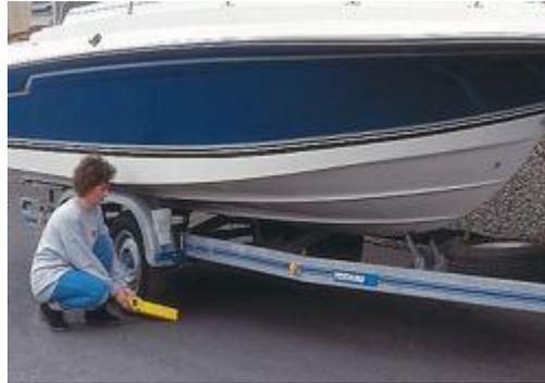
Báscula pesa-ejes PCE-CWC pesando un remolque.
