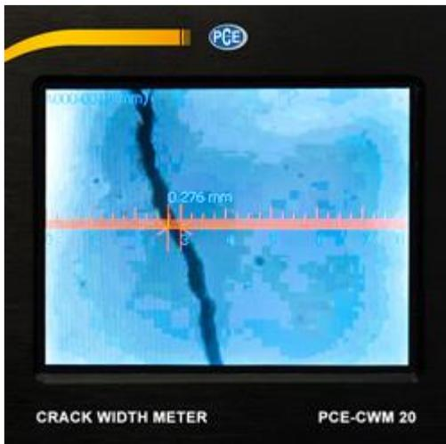
Visualización de la medición en tiempo real en la pantalla LCD del fisurómetro.
