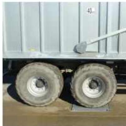
Gracias a los sensores instalados, la plataforma pesa ejes puede detectar automáticamente la cantidad de ejes y calcular el peso total.
