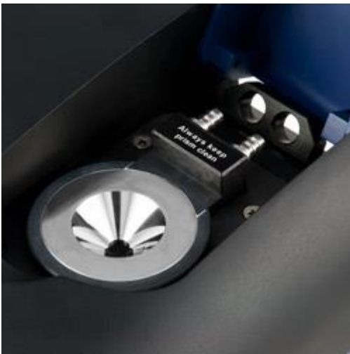
Conexión del refractómetro Abbe para conectar un termostato
