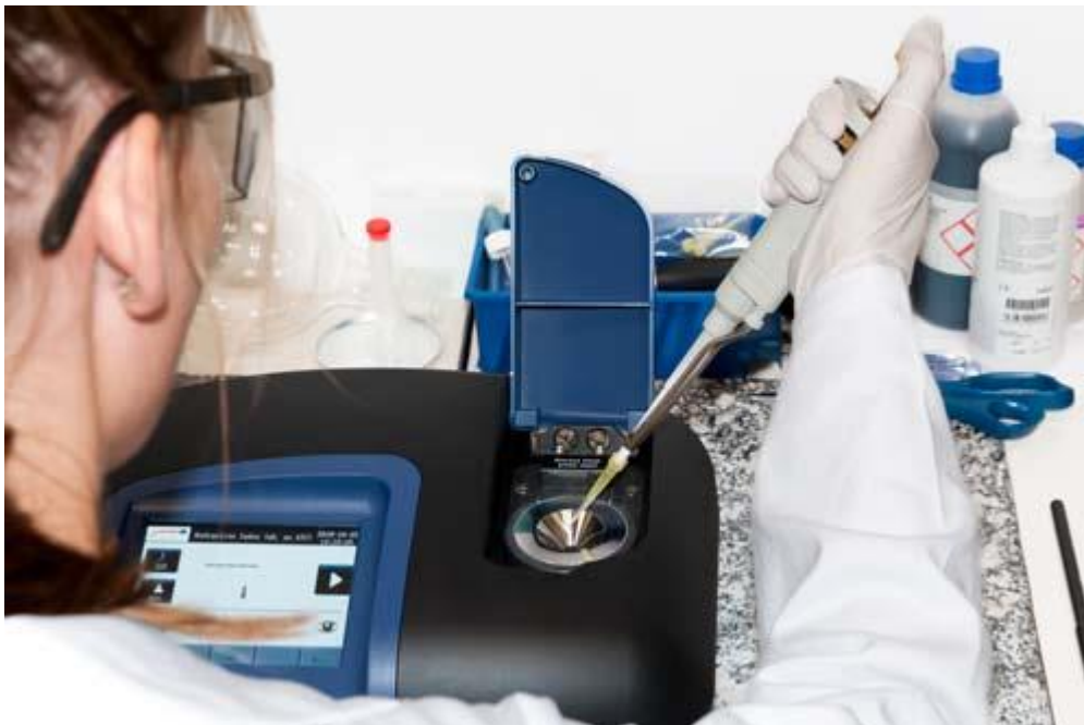
Adición de una muestra al refractómetro Abbe
