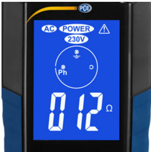
La pantalla del comprobador de tierra muestra una visión general sobre la resistencia de tierra.
