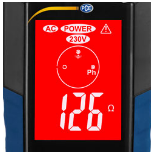
Si la resistencia a tierra es demasiado alta la pantalla del comprobador de tierra cambia a color rojo.
