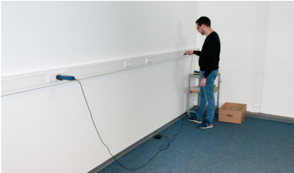
Midiendo con el comprobador de tierra PCE-ECT 50.
