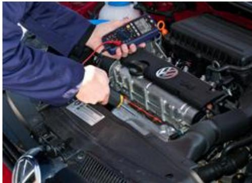
Comprobación de la temperatura de un motor con el medidor multifunción PCE-EM 886
