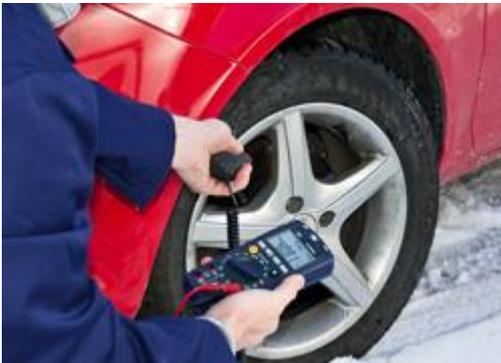
Medición de la temperatura mediante el adaptador externo de temperatura infrarrojo
