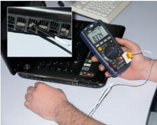
El medidor multifunción verificando una medición de temperatura con una sonda tipo K
