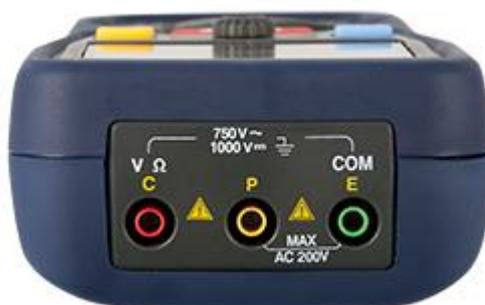
Las conexiones para los cables de prueba están en la parte superior del medidor.
