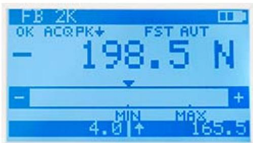
La pantalla del medidor de fuerza universal le informa sobre el estado de batería, la velocidad de medición, la fuerza y los valores mín/máx.
