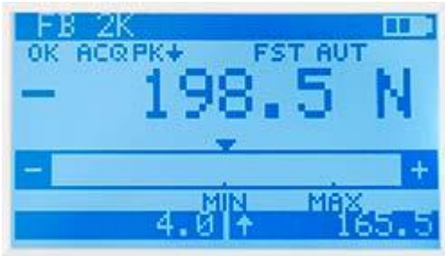
Torquímetro: Información sobre el estado de la batería, la cuota de medición, la fuerza, los valores MAX / MIN
