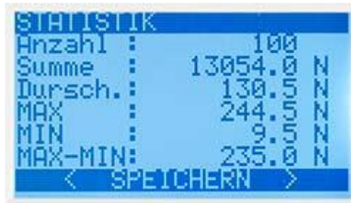
La función estadística del torquímetro con la posibilidad de almacenamiento interno
