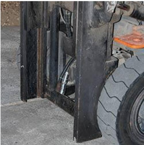
Aquí ve el sensor de la balanza hidráulica PCE-FLW 1 montado en un carro elevador de horquilla Gabelstapler. La balanza hidráulica le permite detectar el peso de una carga de forma cómoda y sencilla. Esto es indispensable sobre todo en instalaciones industriales.
