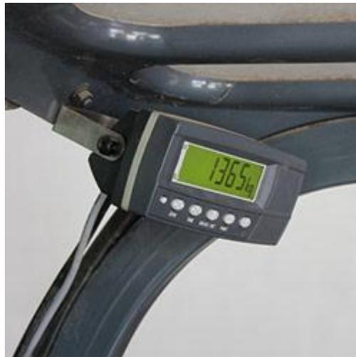
Aquí observar la pantalla de la balanza hidráulica PCE-FLW 1 instalada en la cabina del conductor. El soporte permite instalar la pantalla de tal manera que pueda controlar constantemente el peso.
