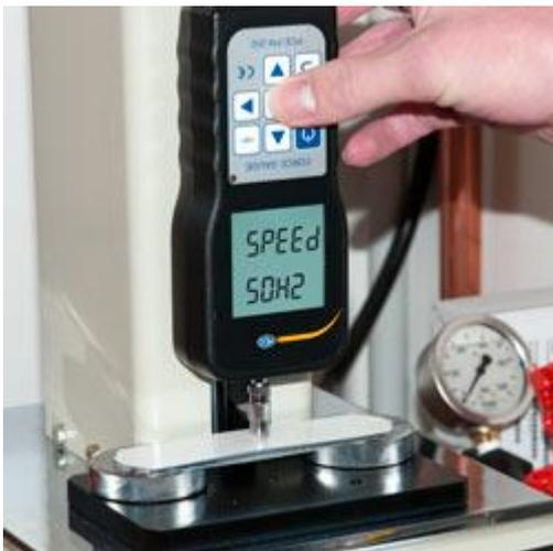
Ensayo de rotura usando el dinamómetro
