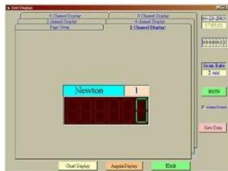
El software opcional permite realizar la transmisión de datos (junto con el cable de datos RS-232) del tester al PC. El intervalo de transmisión es de 1 valor cada 2 segundos. No obstante, el tester registra hasta 4 valores por segundo. Si desea transferir al PC todos los valores que registra el tester de forma simultánea, utilice la Hiperterminal de Windows. De este modo podrá transferir al PC 4 valores por segundo.
