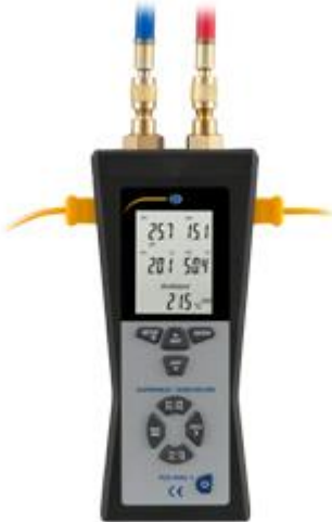
Conexión lateral del manómetro de presión diferencial para un termoelemento.
