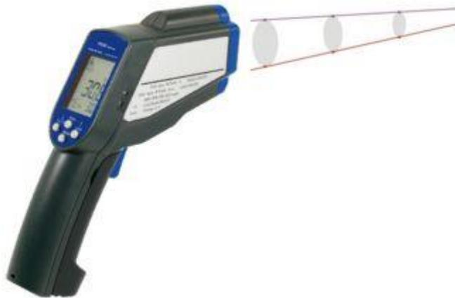
Aquí observa el campo de medición entre ambos rayos láser.
