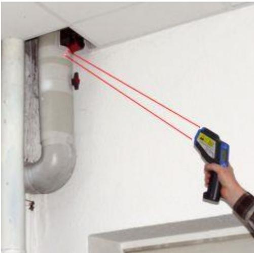
Aquí ve el termómetro infrarrojo haciendo una medición de punto en una bomba de calefacción.
