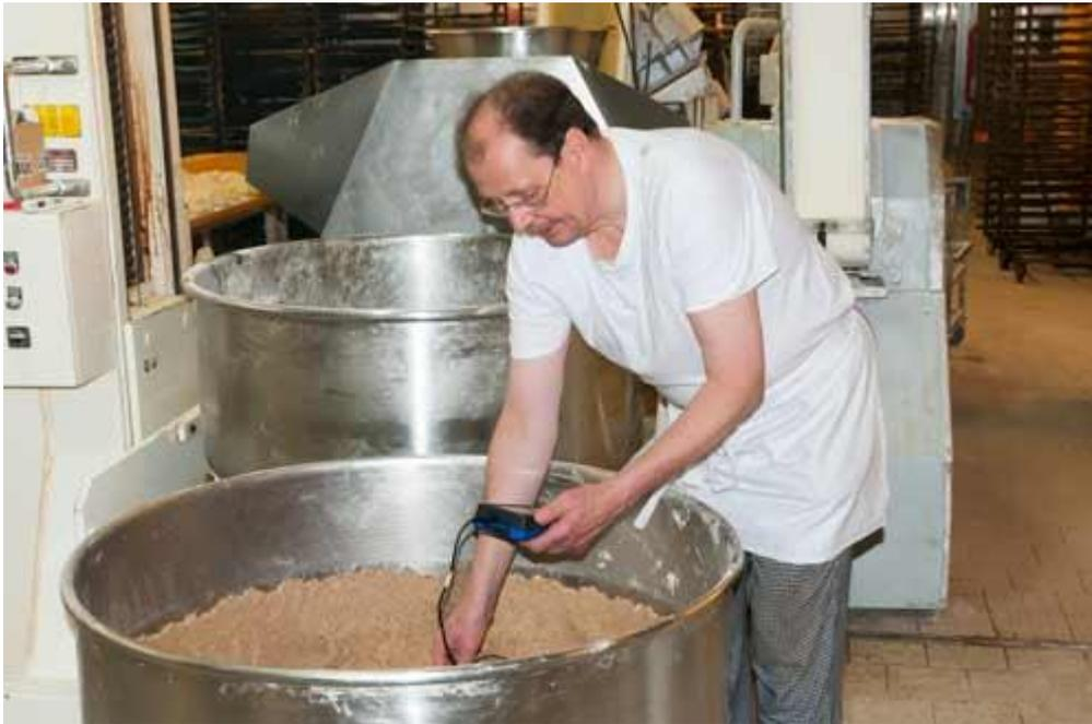
Aquí se aprecia la medición de pH de una masa usando el medidor de pH de la serie PCE-ISFET
