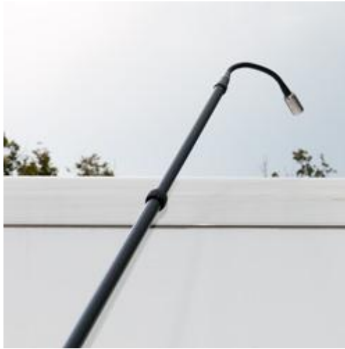
La longitud de la cámara telescópica le permitirá registrar imágenes en alturas elevadas.
