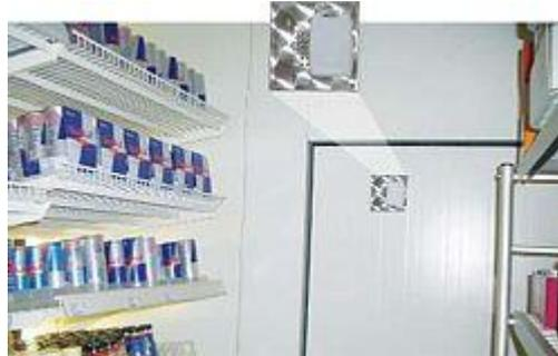
Gracias a que la carcasa de plástico es resistente al agua, y que cumple con la normativa FDA, este registrador de datos para bajas temperaturas se puede usar especialmente en el sector alimenticio
