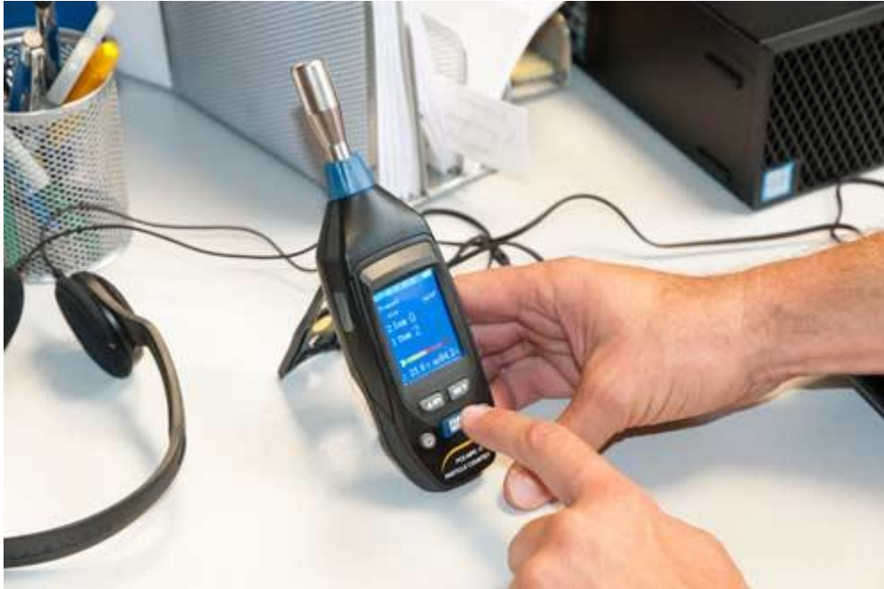
Aquí se observa el medidor de partículas realizando una medición orientativa en una oficina.
