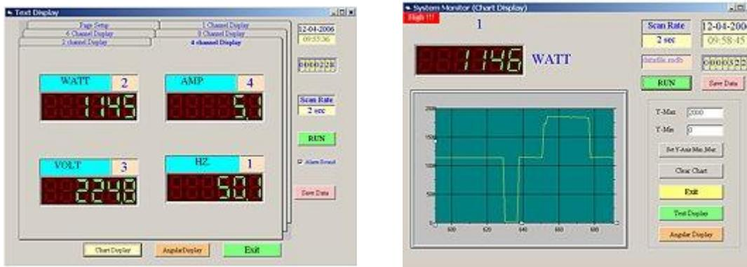
Las imágenes superiores muestran el software de análisis que se envía con el medidor de potencia. Se pueden representar 4 valores de medición a la vez y el indicador gráfico permite realizar cómodamente grabaciones de larga duración que podrá ser valoradas a posteriori.
