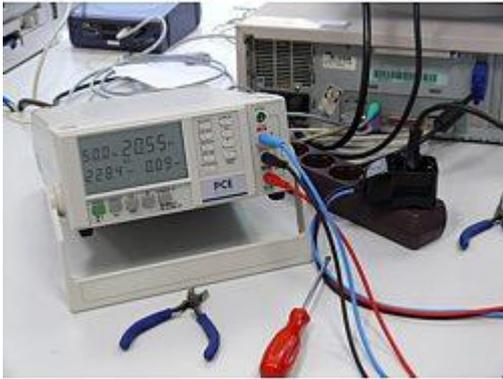
Aquí puede ver la gran pantalla LCD del medidor de potencia que proporciona múltiples informaciones. Se pueden mostrar hasta 4 valores de medición de forma simultánea. El modo de indicación depende de la función dada. Además puede apreciar perfectamente el adaptador de corriente opcional. Sólo es necesario introducir el adaptador en el enchufe y conectar el aparato con enchufe de toma de tierra a dicho adaptador.
