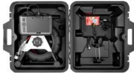
Imagen del maletín de transporte del videooscopio
